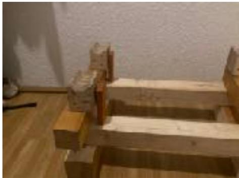
Bild 10: Mögliche Verbesserung durch Stützen auf der Innenseite (Durch orangene Bauklötze dargestellt).
